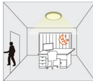
Erfolgt keine Bewegung mehr, dimmt das Licht nach der Haltezeit auf Stand-by-Dimmstufe.
